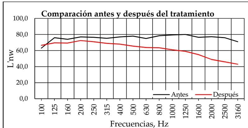
Índice de evaluación efectuada in situ antes y después de la instalación del Ecopet 500.  $L'_{nw} = 19$  dB).
