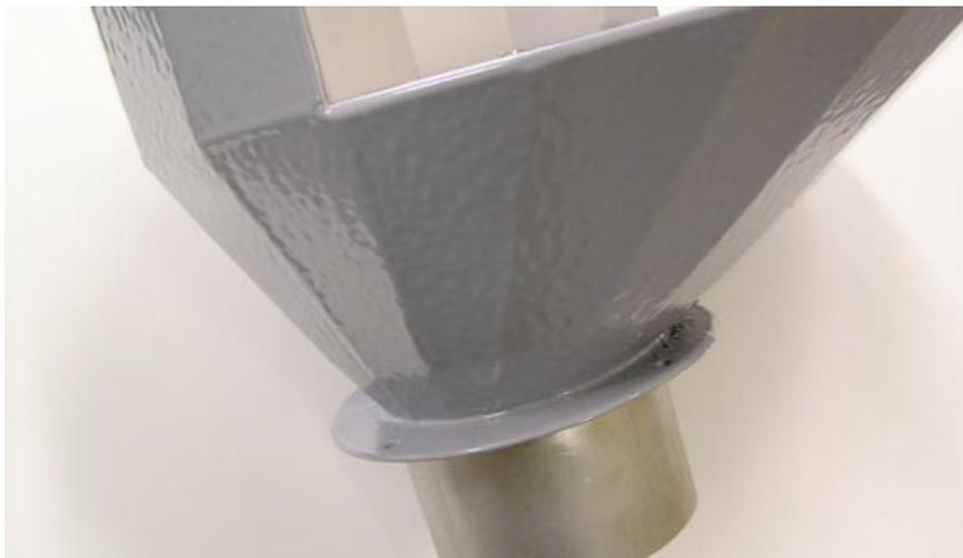
Revestimiento de elemento metálico tratado in situ con Crosone 901
