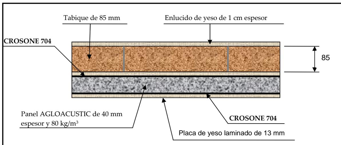
Sección de un tabique de 8,5 cm de espesor con panel AGLOACUSTIC y CROSONE 704 y 1 placa de yeso laminado de 13 mm fijado al tabique con CROSONE 704.
